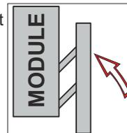
Réarmer le module en relevant la face avant du module jusqu'à l'accrochage de l'ensemble.
